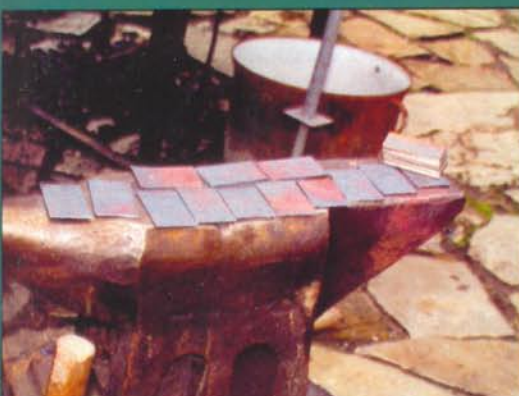
Střídavé skládání pásků do paketu
