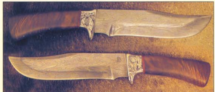
Jin a Jang Michala Roseckého. Damascénská čepel nože má dvakrát tordované jádro, střenky jsou vyrobeny z mrožího klu, ebenu a stříbra; do nýtů jsou vsazeny safíry
